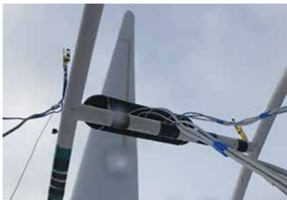
マイクアレーによる風車翼音源の同定実験
